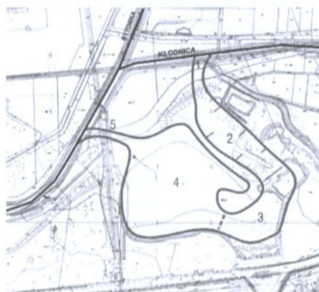
Rys. 1. Szkic proponowanego zbiornika przepływowego.
