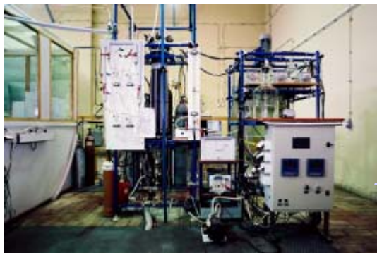
Instalacja (TBR) do bioeliminacji LZO podczas pracy
